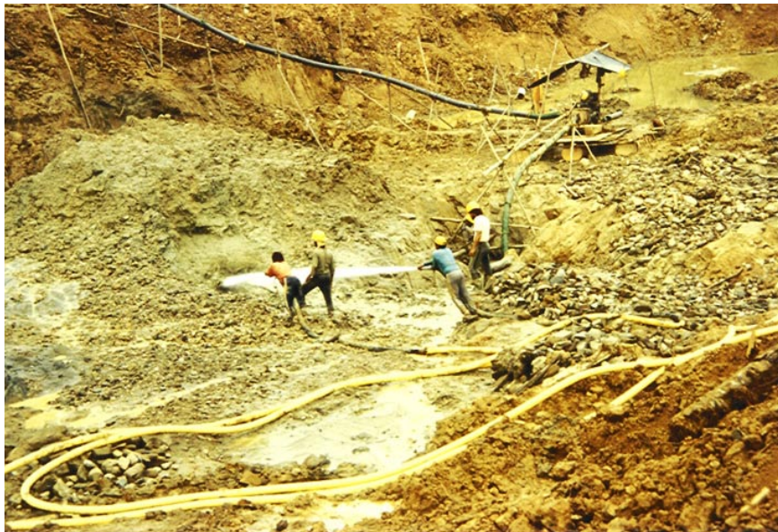
◀ GARIMPEROS BRÉSILIENS UTILISANT LES LANCES À EAU DANS LA MÉTHODE DU LANCE-MONITORING
