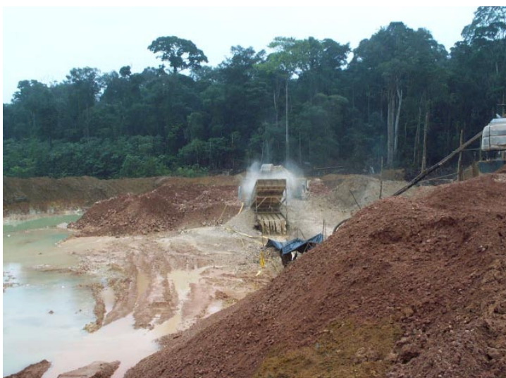
▲ DÉBOURBAGE DES SÉDIMENTS SOUS JETS D'EAU
