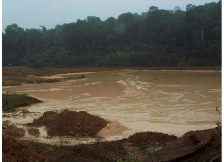
▲ EAUX DE LAVAGE SURCHARGÉES DE BOUES RETENUES DANS UN BASSIN DE DÉCANTATION
