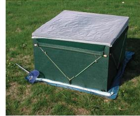
Photo 1 : Biocénomètre à base carrée de 1m<sup>2</sup>
