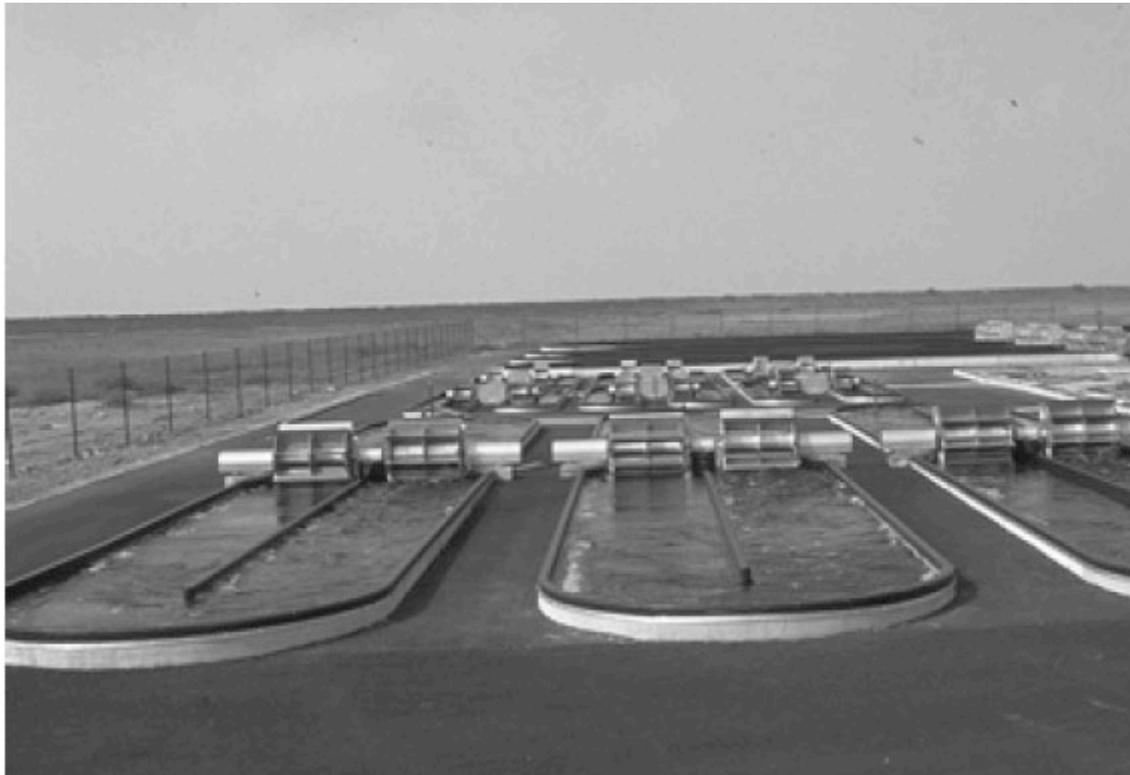
Figure 3 : Système de culture en extérieur du type Raceway (Société Inovalg (85))
