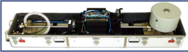
Spectromètre à diode laser modulable pour la mesure en ligne des isotopes du carbone et de l'oxygène
